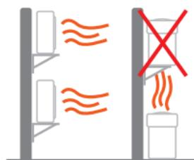
Condensadora com descarga de ar horizontal permite instalação em parede, além de possibilitar posicionar um equipamento acima do outro.
